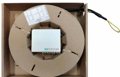
**Boîte de terminaison optique plate en plastique**, préconnectée des **deux côtés**, avec 4 prises SC/APC et tireur ; disponible avec **10m** de câble à 4 fibres pour les installations **FTTH** multi-services ; solution très utile pour amener tous les services centralisés dans le CSOE des installations FTTH à l'intérieur de chaque unité d'habitation individuelle. Il répond aux exigences de la classe **Cca** selon la **norme CPR EN 50575**.
